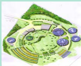
Jardins Filtrants® pour les boues station d'épuration d'Alençon (61)
